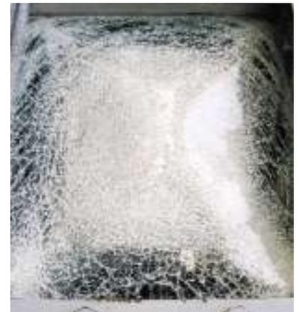
Test de résistance à une déflagration : EN 13541
