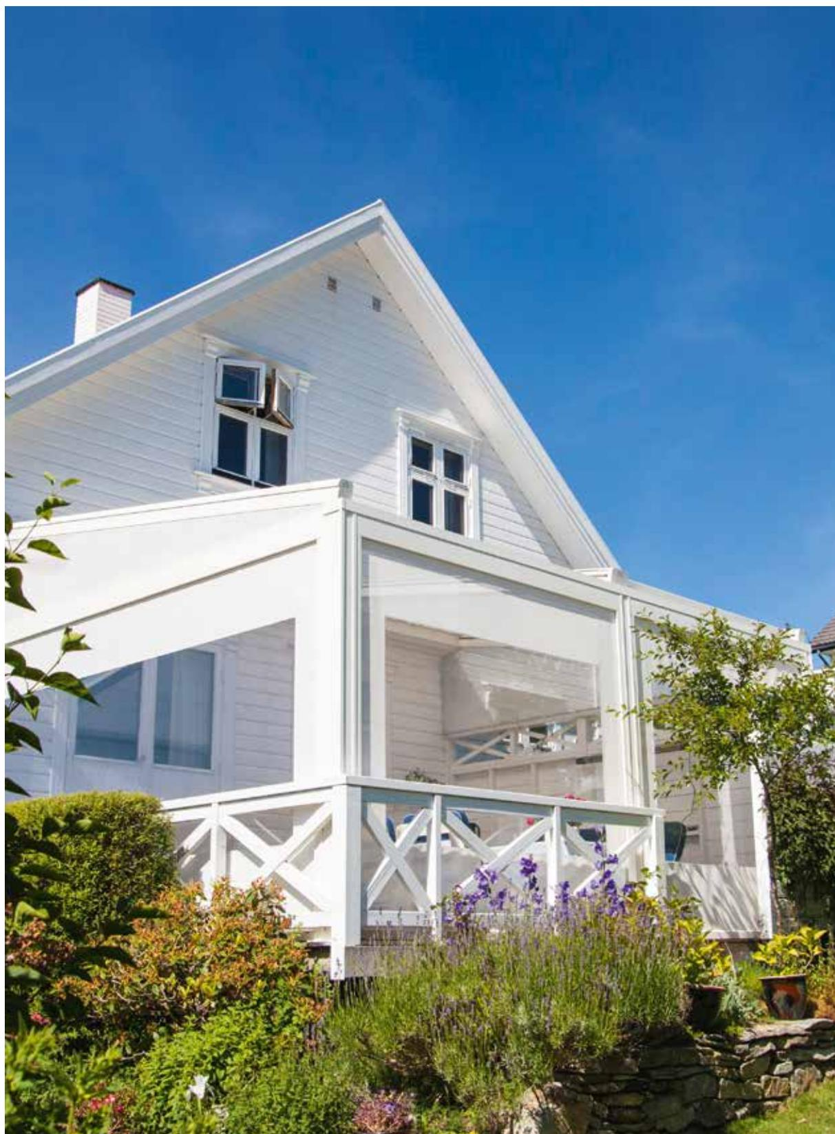
Cette toiture de terrasse est constituée d'une structure en aluminium comportant la technologie Fixscreen intégrée. La protection solaire est entièrement intégrée dans la structure, ce qui forme un ensemble esthétique. Grâce à sa structure modulaire, il est possible d'agrandir la Lagune, même ultérieurement.
